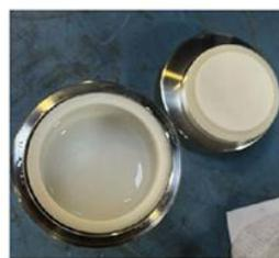
该球磨罐适用于 MSK-SFM-3、MSK-SFM-3-1 或 MSK-SFM-3-II 球磨机，可避免在密闭条件下受到铁或其他无机污染。
