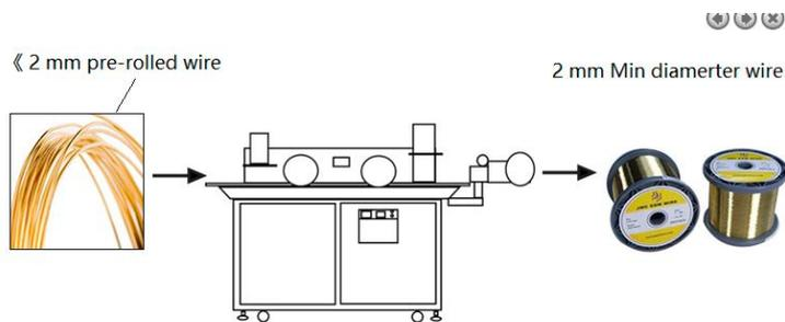
YLJ-WD-1 是一款实验型的单工位拉线机，可以安装有一系列的金刚石拉线模具，可将直径较大的线材从 6mm 拉制到 0.2mm。
