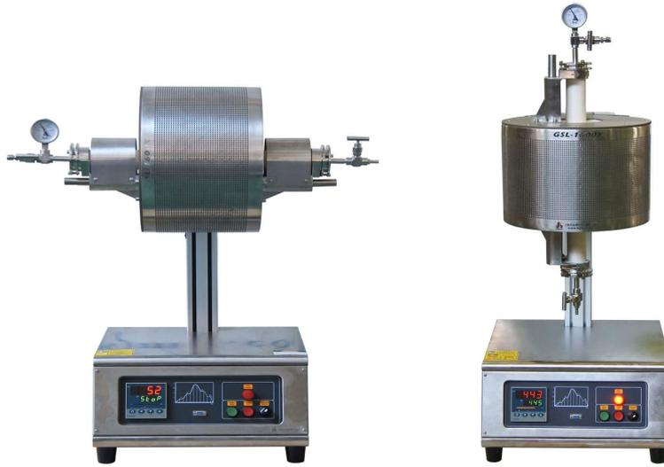
GSL-1600X-VT60 是一款小口径管式炉（1-2”），专为制备小样而设计，最高温度可以达到 1650℃，标配内含刚玉管和一套不锈钢密封法兰，50 段可编程温度控制器，可满足客户升、恒、降温程序段，控温精度±1℃，炉体独特的设计可以水平或垂直切换，以满足不同的应用，如在真空或气氛保护下实现对样品进行烧结、退火和淬火等热处理工艺。
